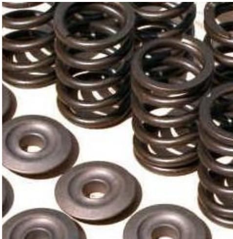
Tra le parti più importanti della testata ci sono le molle, se affidabili si può osare con elevati numeri di giri, altrimenti è un rischio! Il materiale utilizzato per
